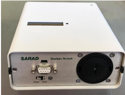
Abbildung 3: Digitales Radon-Messgerät, Radon Scout Plus (Sarad) (Bildquelle: Pamela Jentner)
