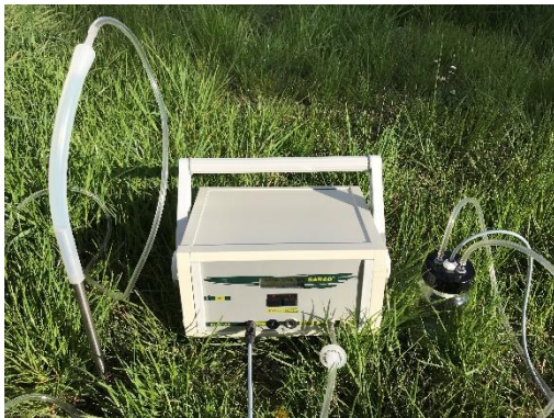
Abbildung 9: Radon-Bodenluftmessung, Radonmessgerät RTM 1688-2 (Sarad) mit Bodenluftsonde (Bildquelle: Pamela Jentner)
