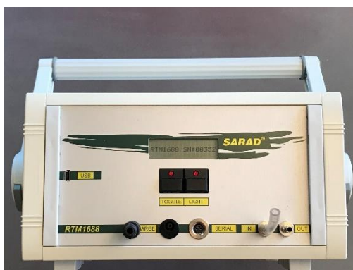
Abbildung 2: Digitales Radon-Messgerät, RTM 1688-2 (Sarad) (Bildquelle: Pamela Jentner)
