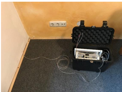
Abbildung 6: Leckagen-Suche: Messung der Luftbewegungen an verschiedenen Stellen, z.B. bei Unterdruck- oder Normaldruck-Situation (Bildquelle: Pamela Jentner)
