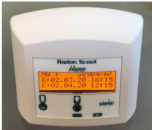
Abbildung 1: Digitales Radon-Messgerät, Radon Scout Home (Sarad) (Bildquelle: Pamela Jentner)
