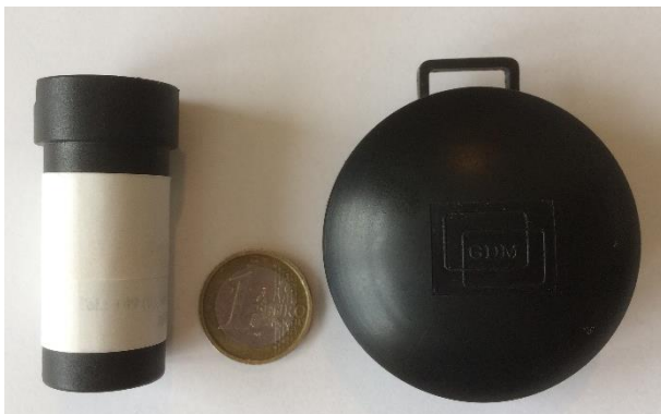
Abbildung 8: „Messdosen“ Kernspurexposimeter, verschiedene Typen, mit Größenvergleich zu 1€ Münze (Bildquelle: Pamela Jentner)
